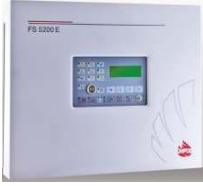
FS 5200E Yangın Söndürme Paneli • Söndürme modülü dahildir • 3 adet sabit zon • LCD ekran • Yangın söndürme amaçlı 2 adet yangın alarm zonu • Yangın söndürme kontrolü olmayan 1 adet yangın alarm zonu • RS485 arayüzü • Ana güç beslemesi: 220/230 VAC • Yedek besleme.: 2 x 12 V/7Ah • Besleme tüketimi: 50 mA • AUX çıkışı: 24 VDC/ 0.3A • Bataryanın iç direnci: 1,6 \Omega 'dur • Çalışma ısısı: -5°C ÷ +40°C • Ağırlık (bataryasız): 6.6 kg • Boyutlar (plastik kutu): 450x355x115 mm
