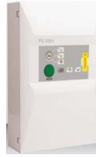
FS 5301 Uzaktan Söndürme Modülü • 5200 E serileri ile uyumlu • Çalışma ısısı: -5°C ÷ +40°C • Yedek besleme.: Kontrol panelinden gelen güç • Ağırlık (bataryasız): 1.125 kg • Boyutlar (plastik kutu): 315x220x95 mm • Otomatik/manuel mod veya sadece manuel mod seçme özelliği
